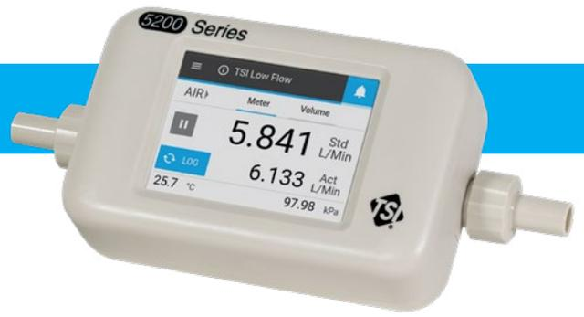
5200 系列是 TSI 公司出品的低流量热式质量流量计。此流量计对小于 1 L/min 的流速提供更高的分辨率和精度。5200 系列流体的内部容积减小了，最大程度地减少回路死区，并提供高度精确的容积测量。TSI 的低流量计被用作流量参考值，用于校准采样仪器以及许多其他低流量应用。
