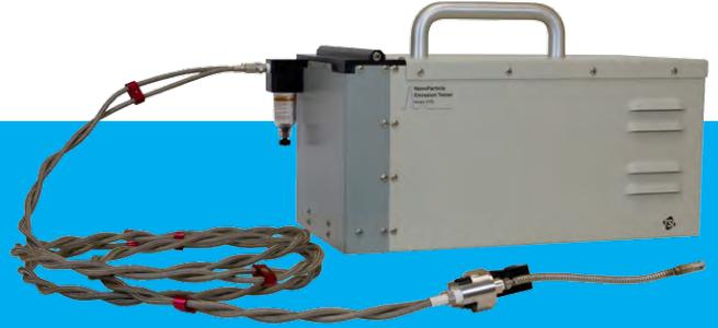
TSI 3795型纳米颗粒物排放测试仪 (NPET) 是一款便携式，精确的仪器，能够测量各种柴油动力源（包括建筑机械，公共汽车，固定发电机组等）的总固体颗粒物排放量。NPET具有坚固，人性化的设计，研究人员，监管检查人员和维护人员均可在野外使用NPET。
