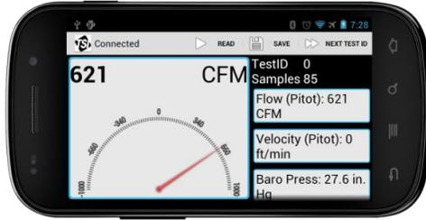
利用无线蓝牙®技术，此应用程序适用于基于Android™的智能手机和平板电脑，可与仪器进行远程通信，距离相距100英尺（30.5 m）远，并实时显示样品数据。附加评论，语音注释和照片以测试ID数据，以通过电子邮件导出以生成报告。
