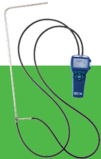
DP-Calc 5815和5825显微压力计使您可以轻松进行HVAC压力测量。这些坚固的仪器可与皮托管探头一起使用，以测量管道速度。DP-Calc 5815是一款易于操作的手持式数字压力计，可快速、准确地测量差压和静压。高性能DP-Calc 5825可以计算流量并具有数据记录功能。
